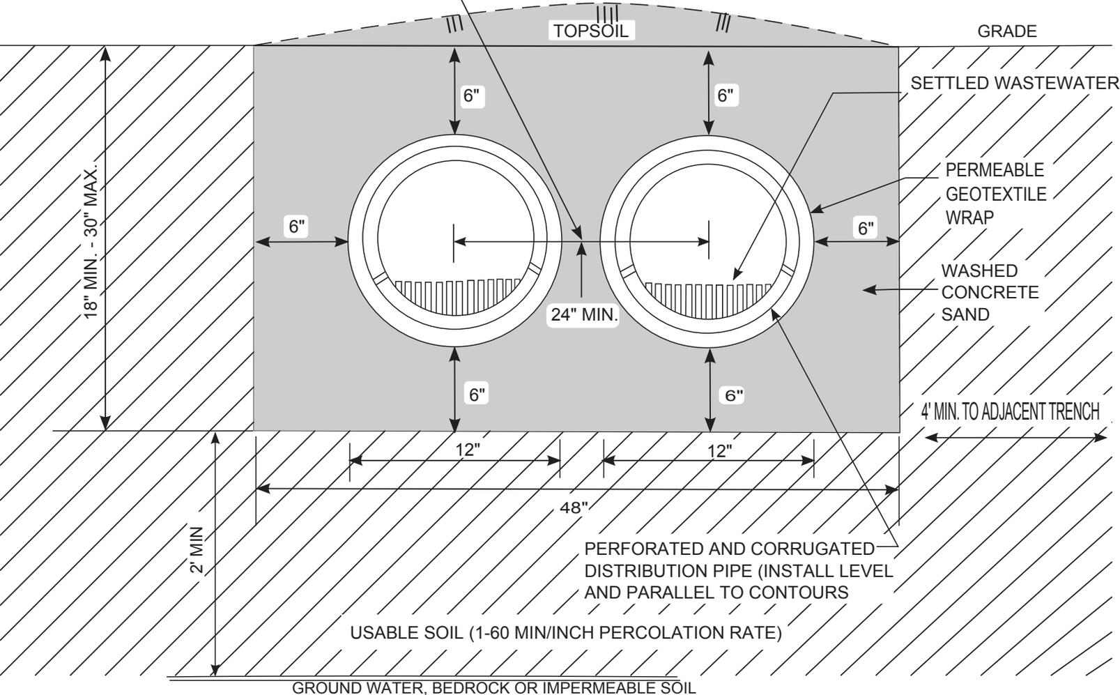
**FIGURE 21: TYPICAL GRAVELLESS GEOTEXTILE SAND FILTER SYSTEMS**
